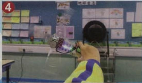
▲步驟 4：測試效能的風力發電機組由大會統一提供，學生把設計的風車裝上，面向大風扇，機組上會顯示讀數，比賽便根據風車推動發電機的效能定勝負。黃諾詩補充說，比賽當日學生盡快完成風車製作，再不停測試及調整，希望在限時內可得出最高的發電效能。
